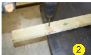
2 - Percer le longeron au centre diamètre 8 à l'aplomb de la lumière de flotteur soit 4 percements par longeron)
